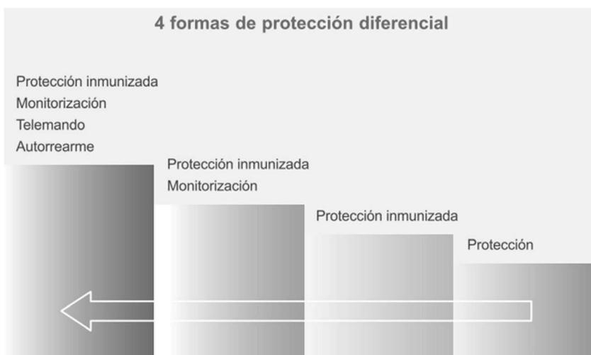
Figura 1. Métodos de protección diferencial.
