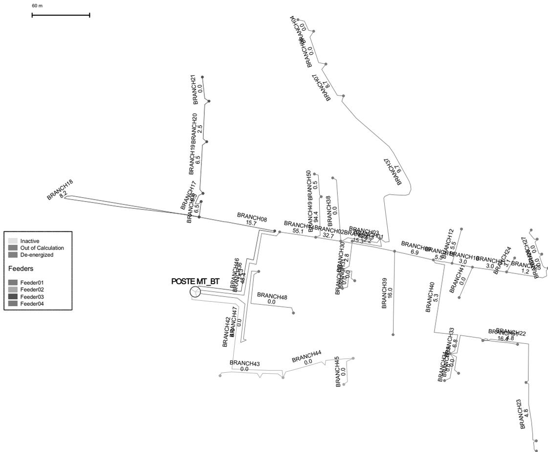
Figura 2. [Fuente ERDF] Red de baja tensión.
