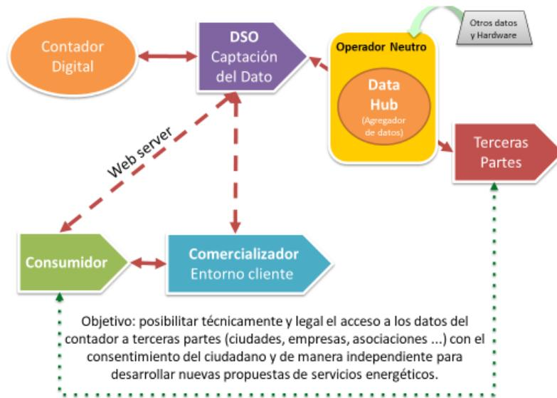
Figura 3. Diagrama de flujo de la información de los contadores digitales hacia el consumidor, la compañía eléctrica comercializadora y terceras partes. Fuente: Salas 2017.
