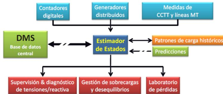
Figura 1. Herramientas de monitorización y diagnóstico en tiempo real en redes de MT/BT.
