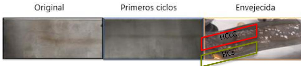
Figura 2. Análisis visual del electrodo negativo, comparación entre la muestra nueva y la envejecida.
