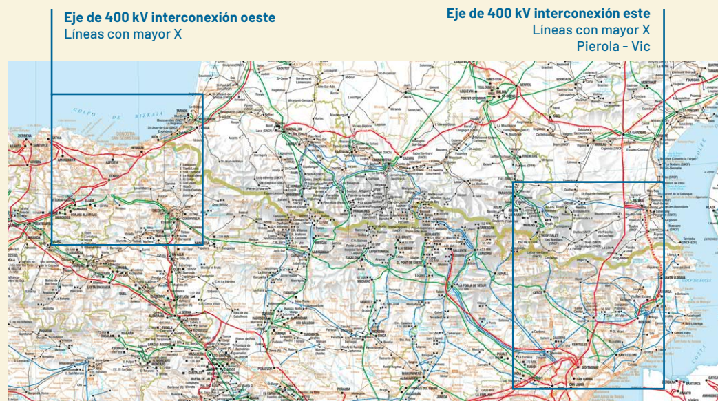
Figura 8. Líneas de los dos ejes principales de interconexión con Francia
